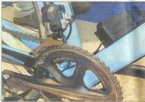
Hat den Hätettest an der Tour de France bestanden: elektronisches Schaltwerk von Shimano.
